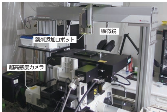
図4 細胞内1分子イメージング自動解析システムAiSIS イメージング用超高度感度カメラ、全反射照明光学顕微鏡、薬剤添加ロボット部から構成される。1分子イメージングに必要な全工程を自動で行う。1日に約1,600細胞の1分子イメージング解析が可能。
