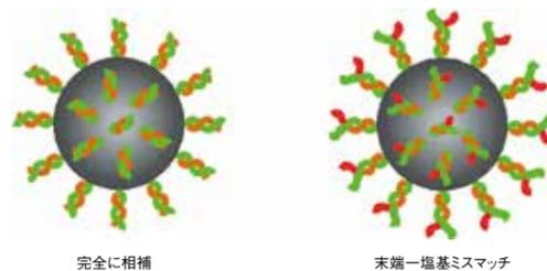
● 図2 2本鎖DNAを固定した金ナノ粒子の凝集の有無を利用した水銀イオンの目視検出
