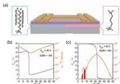
(a) 正孔が流れるべき箇所にフッ化アルキル処理（青色）、電子が流れるべき箇所にアミノアルキル処理（ピンク色）を施したもの。
