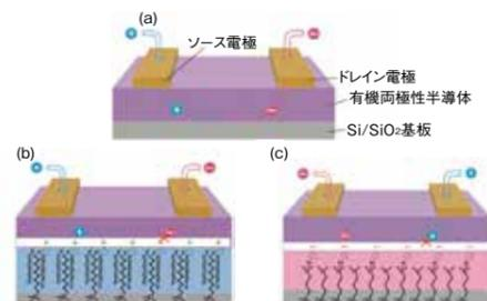
(a) 有機両極性半導体中の電荷の移動。正孔（プラス）、電子（マイナス）が無差別に伝導してしまう。
