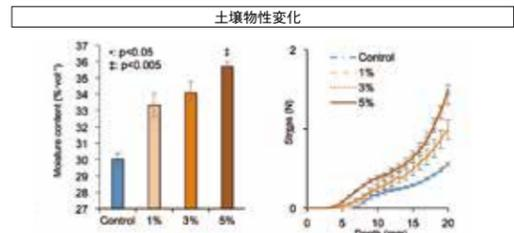
左:土壌改良による保水能力の変化。半炭化バイオマスの混合率が1%、3%、5%と増えるに伴って土壌中の保水性も向上している。
