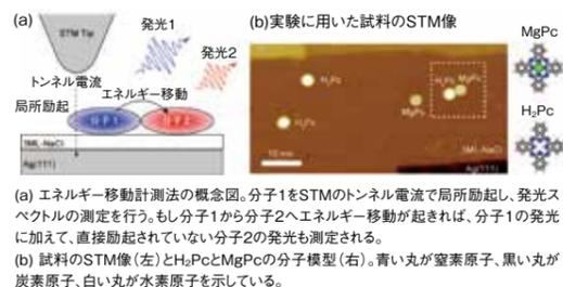
● 図2 分子間エネルギー移動を示すSTM発光スペクトルとSTM像
