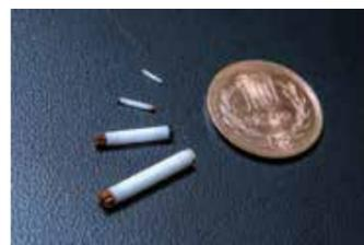
上:マジックアングル試料回転(MAS)法の測定に開発したもの。商品化されたものとしては世界記録となる120 kHz(1秒間に12万回転、7,200,000 rpm)という超高速の試料回転を実現している。
